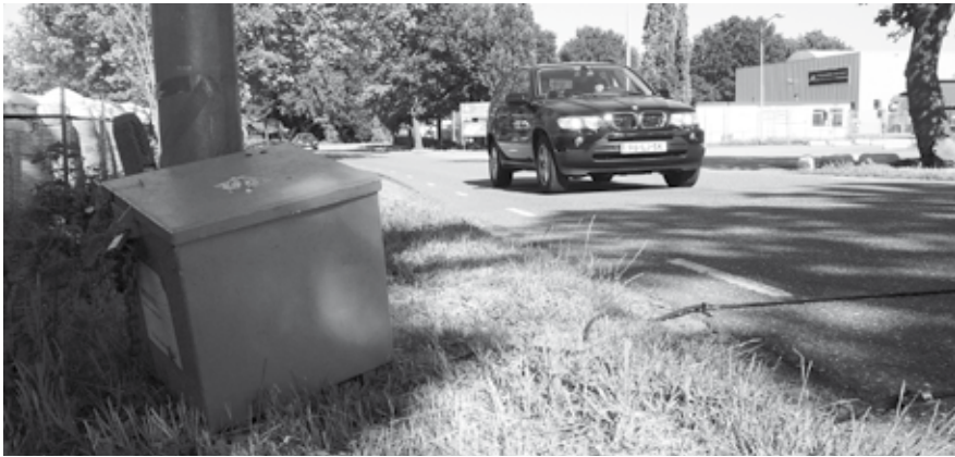
Ook op het bedrijventerrein Aan Veertien stond een telkast voor het verkeersonderzoek. Foto: gemeente Nederweert
