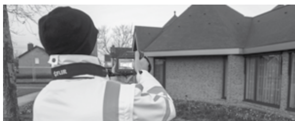
Met een warmtebeeldcamera onderzoekt een medewerker de gevel op warmtelekken. Foto: Nederweert24
